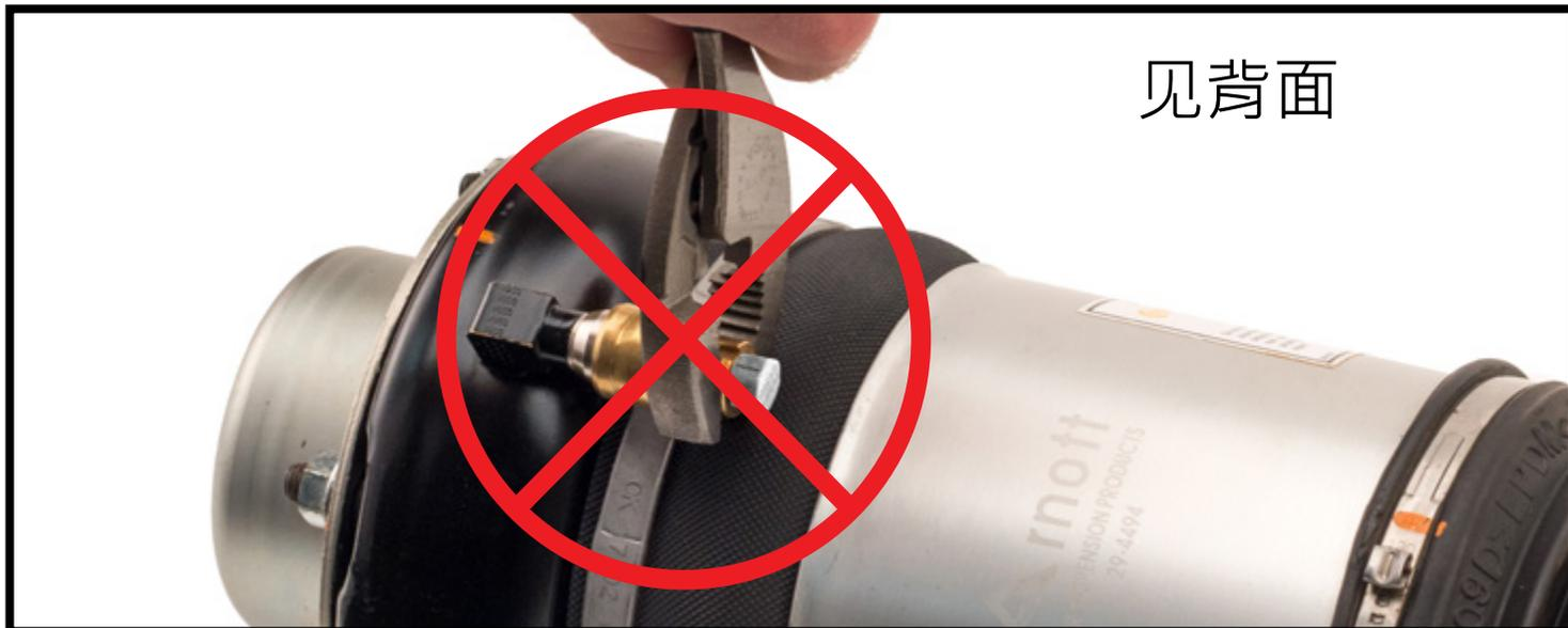
本产品发货时已加压；安装之前，请按压空气弹簧的外露部分，进行适当充气。发硬的空气弹簧类似下图。如果空气弹簧未充气或与下图不符，请联系您的授权零售商。
